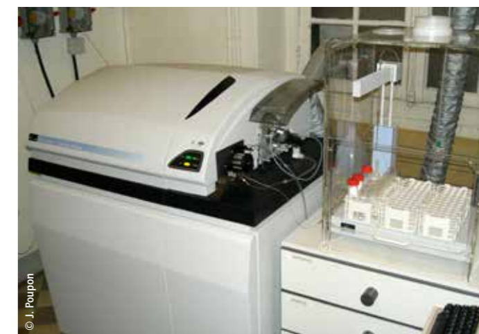
La spectrométrie de masse avec plasma à couplage inductif (ICP-MS) est une méthode plus récente de dosage de la plombémie.
